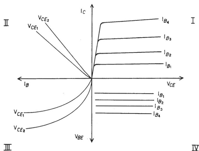
Fig. 2 - Alcune fra le più importanti « famiglie » di curve caratteristiche, relative al montaggio ad emettitore comune.
