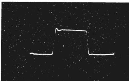
Fig. 11 - Su carico capacitivo, l'amplificatore resta perfettamente stabile.
