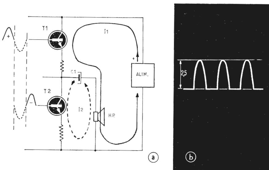
Fig. 5 - Principio di funzionamento (a) e forma della corrente richiesta da uno stadio di uscita classico (b).
