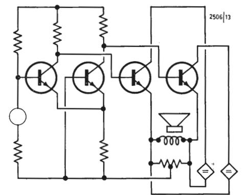
Fig. 3 - Schema base di stadio finale con alimentazione a ponte.
