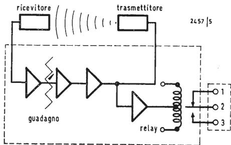
Fig. 1/0950 - Schema a blocchi del «Sonac».
