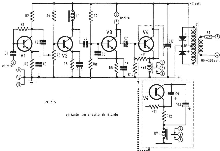
Fig. 2/0950 - Schema dell'amplificatore per l'apparecchiatura a due trasduttori e variante con circuito di ritardo.
