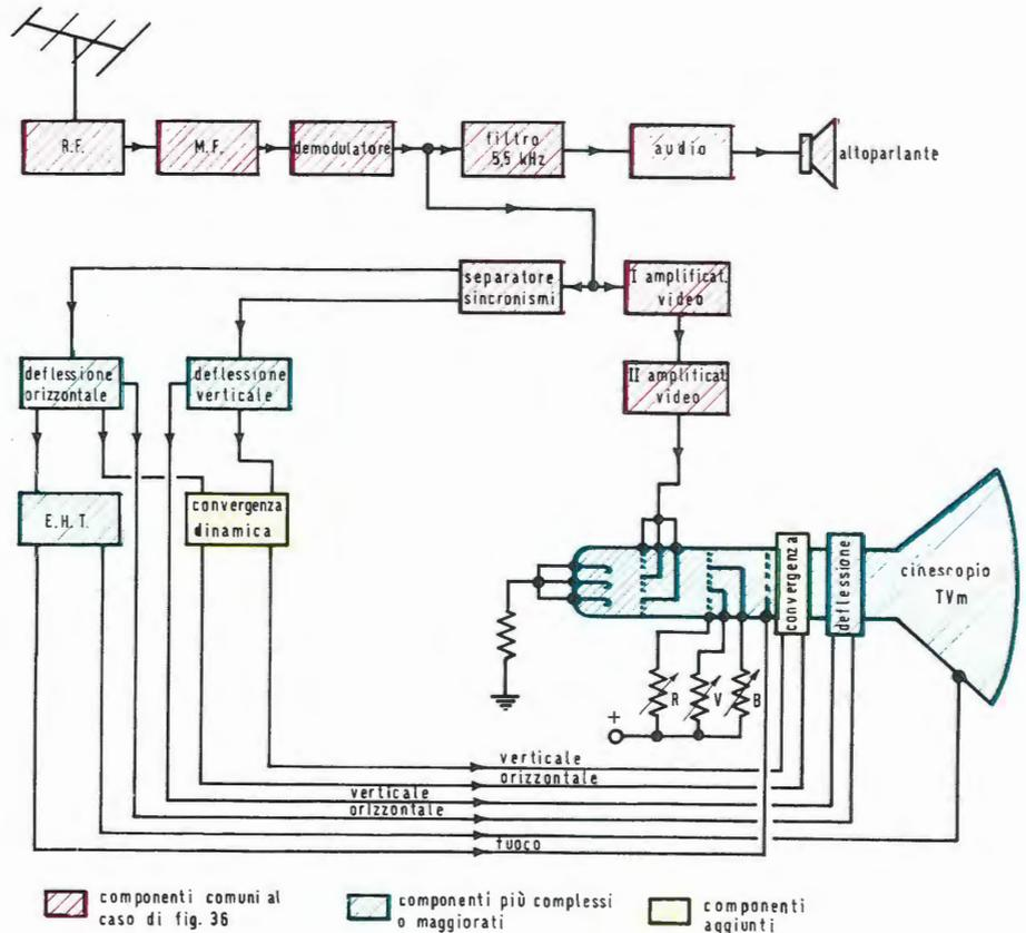
Fig. 37 - Schema a blocchi di un ipotetico televisore TVm a cambiamento di colore.
