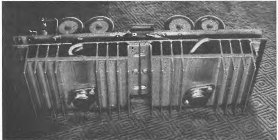
Fig. 14b - Viste di sotto e di sopra del modulo alimentatore previsto per due amplificatori di potenza.
