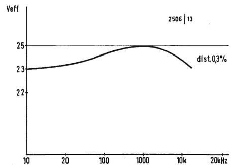
Fig. 12 - Potenza massima ottenibile sulla banda 10 c/s 10 Kc/s per dist. 0,3%.
