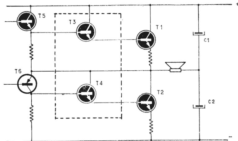
Fig. 8 - Schema di principio dello stadio « tampone » ( $T_3$  e  $T_4$ ) disposto fra la coppia complementare ( $T_5$  -  $T_6$ ) e il controfase di uscita.
