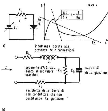
Fig. 3 - Circuito semplificato che permette il rilievo della caratteristica di un diodo tunnel ed il tracciamento della retta di carico per un funzionamento bistabile (a). Schema equivalente di un diodo tunnel nella zona a resistenza negativa (b).
