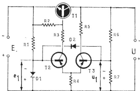
Fig. 1 - Schema teorico dell'alimentatore regolato protetto.
