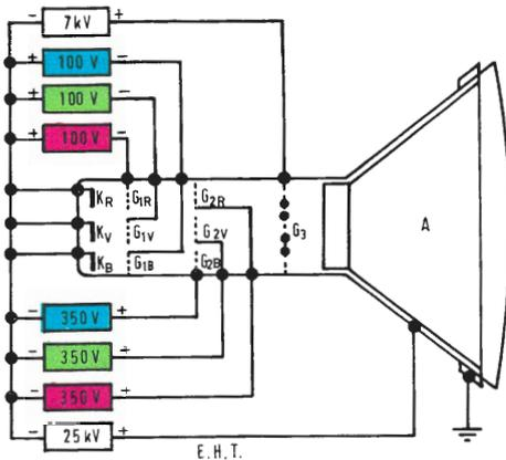
Fig. 35 - Polarizzazioni di un cinescopio tricromico a tre fasci.
