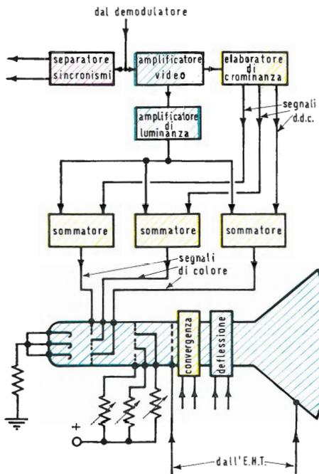
Fig. 39 - Pilotaggio del cinescopio tricromico con i segnali di colore.
