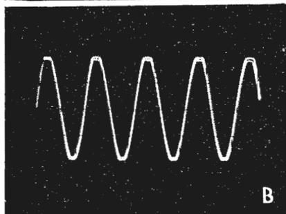
Fig. 12 - Oscillogramma di un segnale a 1 kHz corrispondente alla potenza di 120  $W_{eff}$  (A); verifica della perfetta simmetria di tosatatura (B).
