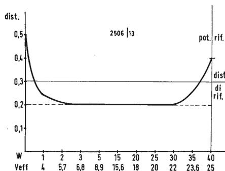
Fig. 11 - Curva distorsione-potenza riferite allo 0,3% e 40 W ( $16 \Omega$ ).
