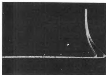
Fig. 14 - Caratteristica del breakdown di un BC109 al silicio plan. epitass. Si noti la estremità della curva, « a resistenza negativa ».
