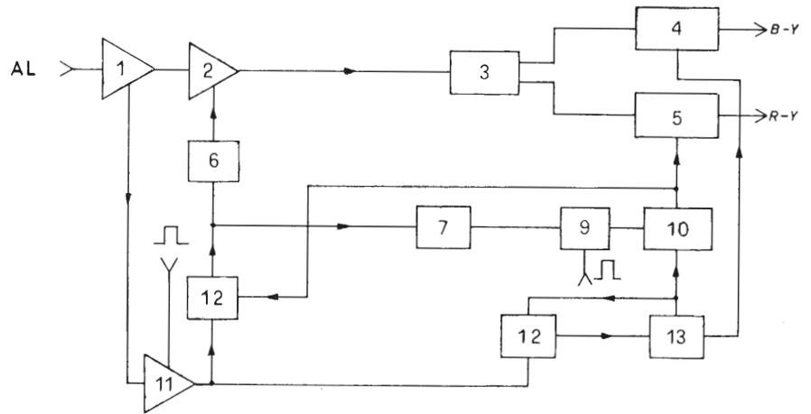
Fig. 2a - Schema a blocchi della nuova identificazione PAL con soppressore del colore. Diciture 1, 2, 3, 4, 5, 6, 9, 10, 11, 12 e 13 come in fig. 1; inoltre 7 = Stadio di bloccaggio flip-flop.
