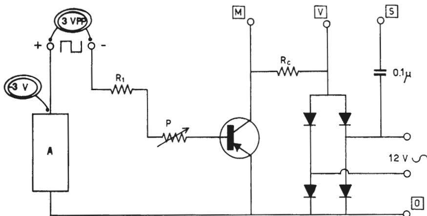
Fig. 10 c - Come collegare il generatore ad onda quadra (o, eventualmente, a gradini). Nel caso di un'onda quadra, la  $I_b$  può esser dedotta da semplici considerazioni:
