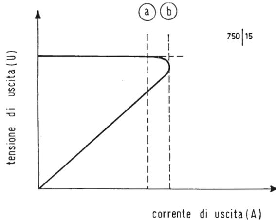
Fig. 2 - Curva corrente-tensione dei circuiti di fig. 1 e 3.
