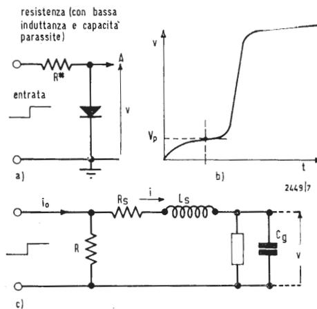
Fig. 6 - Configurazione circuitale per la misura dei tempi di commutazione (a) e forma d'onda della tensione nel punto A (b). Schema equivalente del diodo tunnel per l'analisi dei tempi di commutazione. La funzione  $i/v$  è rappresentata dal simbolo rettangolare collegato in parallelo su  $C_j$  (c).
