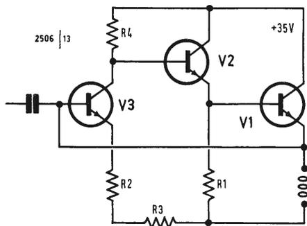
Fig. 4 - Schema di principio per uscita di emettitore.
