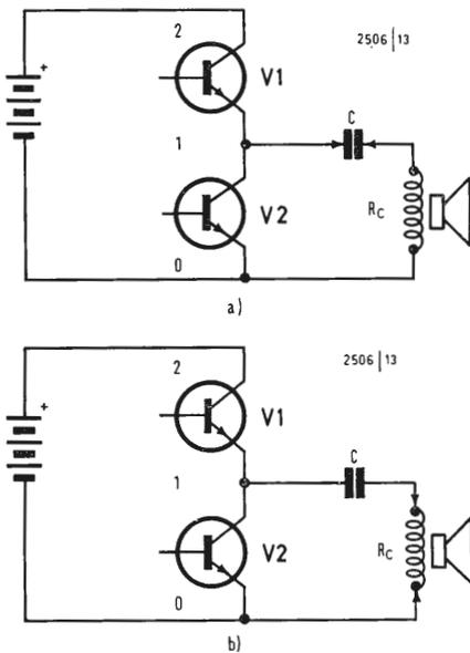
Fig. 1 - a) Percorso corrente, semiciclo positivo; b) percorso corrente, semiciclo negativo.
